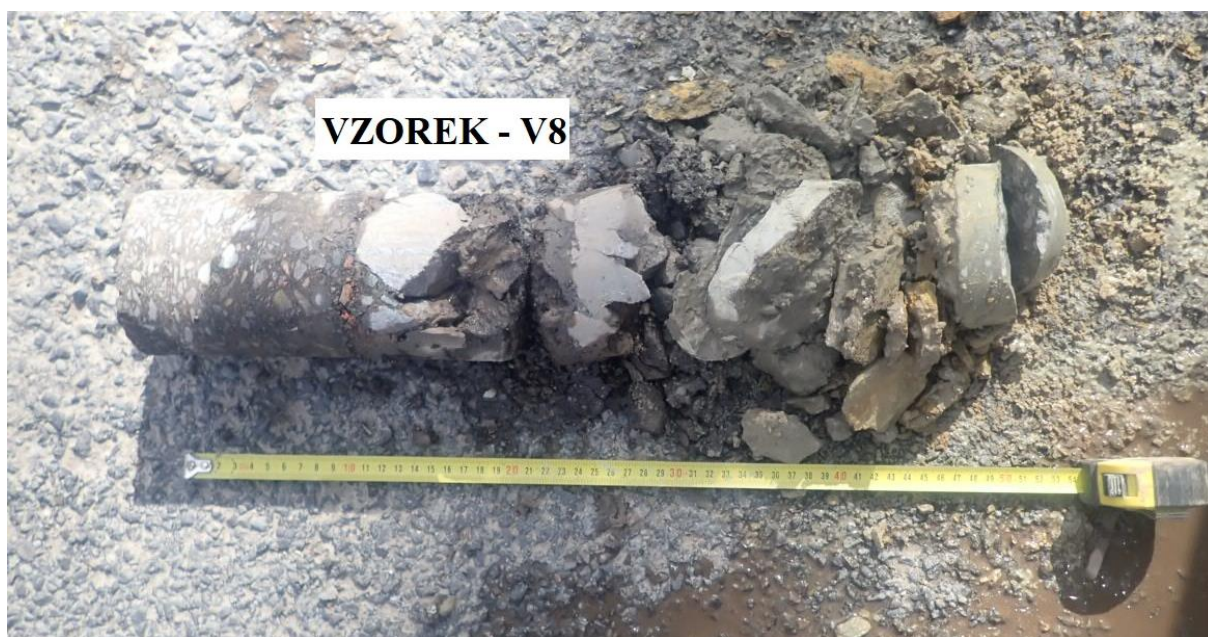
Obr. 15 - Jádru vývrtu Vzorek – V8 (in situ).
