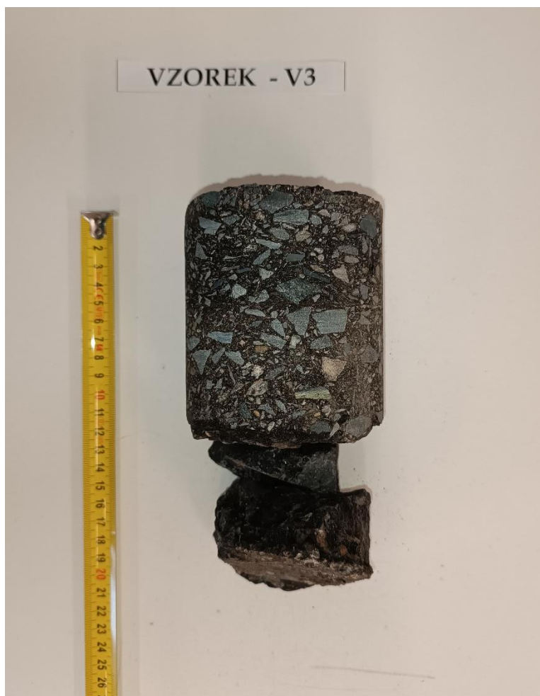
Obr. 6 - Jádru vývrtu Vzorek – V3 (laboratoř).
