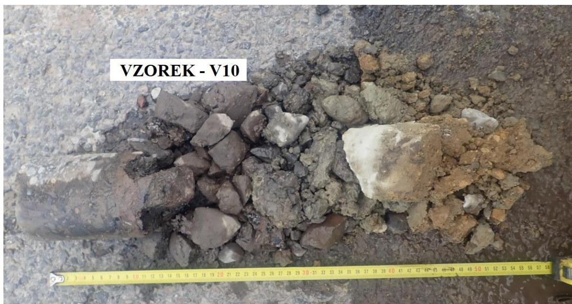
Obr. 19 - Jádro vývrtu Vzorek – V10 (in situ).
