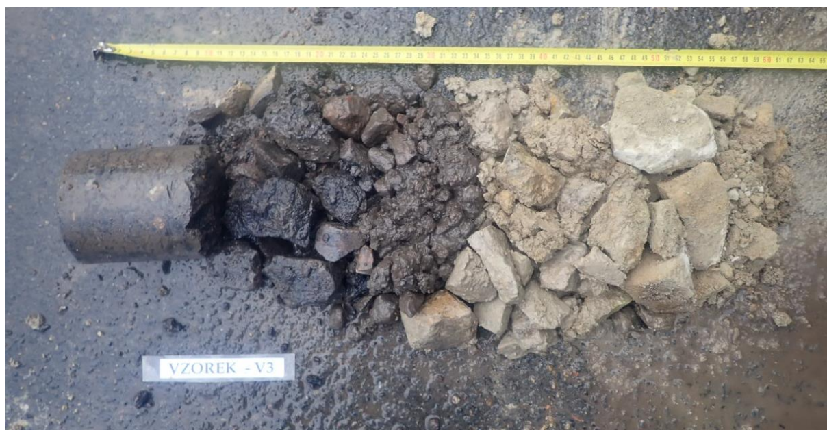
Obr. 5 - Jádro vývrtu Vzorek – V3 (in situ).
