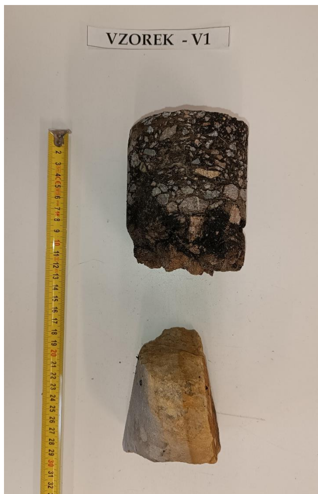
Obr. 2 - Jádru vývrtu Vzorek – V1 (laboratoř).
