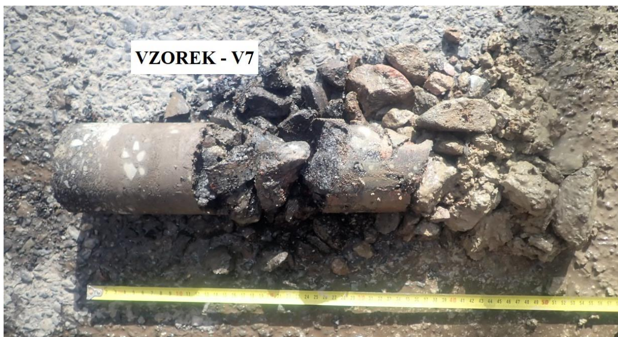
Obr. 13 - Jádro vývrtu Vzorek – V7 (in situ).
