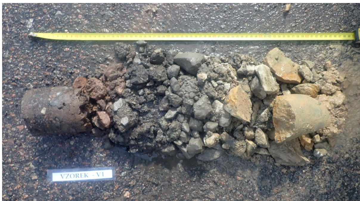
Obr. 1 - Jádro vývrtu Vzorek – V1 (in situ).
