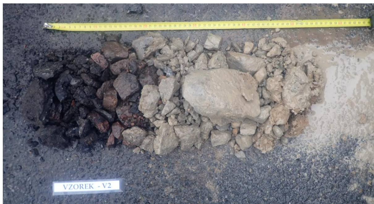
Obr. 3 - Jádro vývrtu Vzorek – V2 (in situ).
