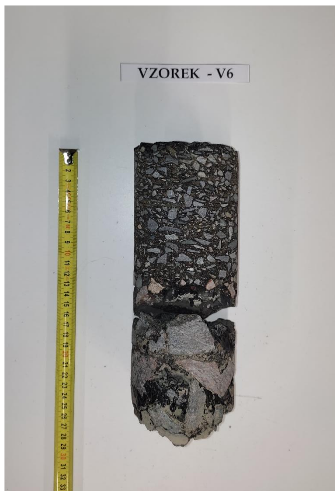
Obr. 12 - Jádro vývrtu Vzorek – V6 (laboratoř).
