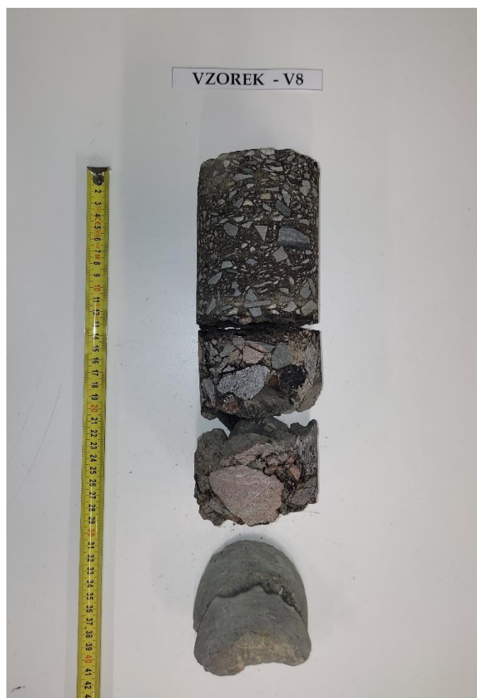
Obr. 16 - Jádru vývrtu Vzorek – V8 (laboratoř).
