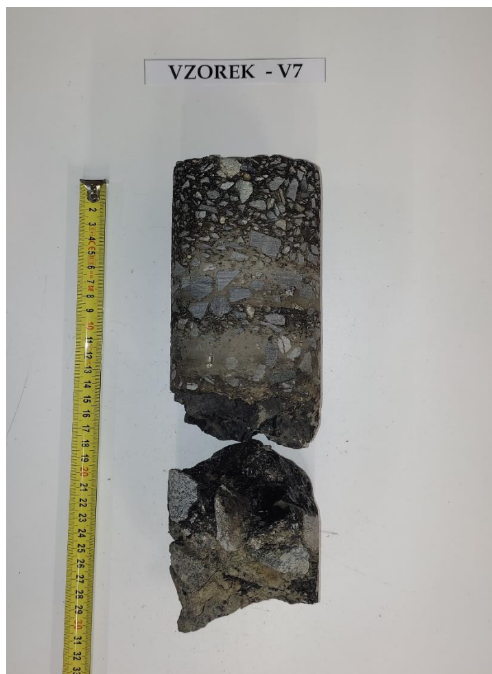
Obr. 14 - Jádro vývrtu Vzorek – V7 (laboratoř).
