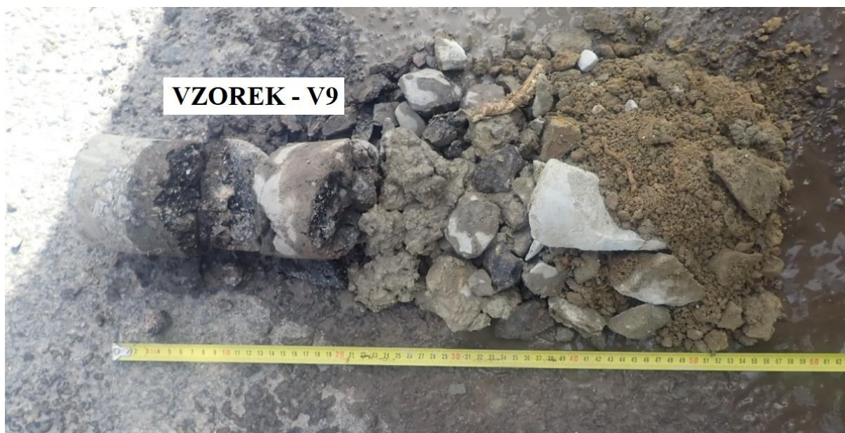
Obr. 17 - Jádru vývrtu Vzorek – V9 (in situ).
