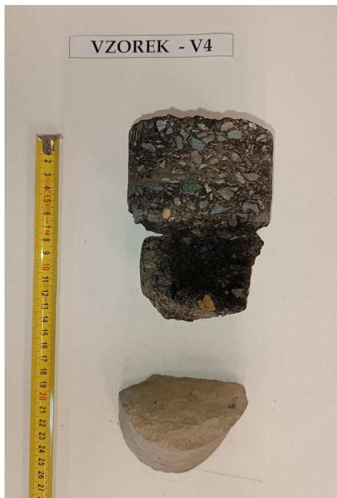
Obr. 8 - Jádru vývrtu Vzorek – V4 (laboratoř).
